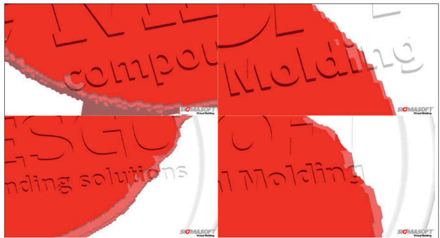
Abb 3 Die erhabenen kleinen Buchstaben füllen langsamer als die dickwandigen Bereiche darunter (oben links), was zu Lufteinschlüssen in ihren Ecken führt (Buchstabe „d“ – oben rechts), bei ins Bauteil vertieften Buchstaben verbessert sich das Füllverhalten deutlich (unten).
